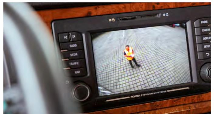
Ein Kamera-Monitor-System kann unterstützen. Wer zum Beispiel bei schlechter Sicht oder einem Ausfall nicht sicher rückwärtsfahren kann, muss sich von einem Menschen einweisen lassen.
