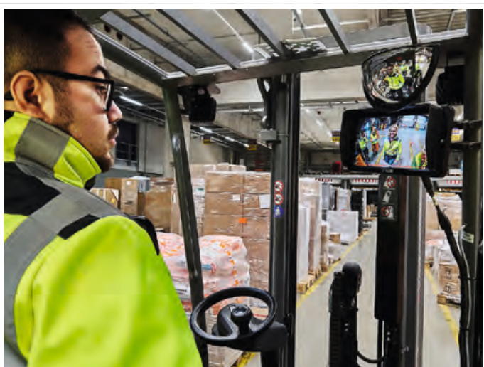
Justin Grunwald demonstriert im Gabelstapler die Sicherheitsbügel und die Rückfahrkamera. Die Personenerkennung löst eine Vollbremsung aus, wenn sich eine Person im Gefahrenbereich befindet.
