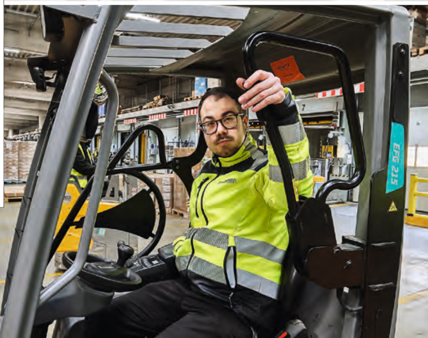
Justin Grunwald demonstriert im Gabelstapler die Sicherheitsbühel und die Rückfahrkamera. Die Personenerkennung löst eine Vollbremsung aus, wenn sich eine Person im Gefahrenbereich befindet.
