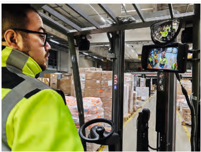
Justin Grunwald demonstriert im Gabelstapler die Sicherheitsbühel und die Rückfahrkamera. Die Personenerkennung löst eine Vollbremsung aus, wenn sich eine Person im Gefahrenbereich befindet.
